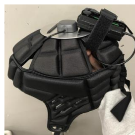
図 1. 本開発におけるセンサ装着方法
