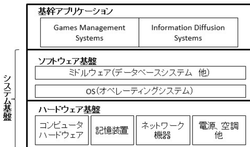
図 3 オリンピック IT システムの構造（筆者作成）
