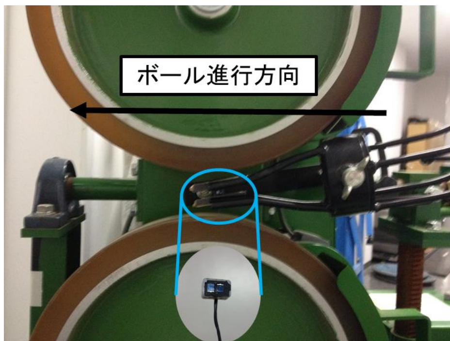
図 2-3 センサの貼付位置と感光ダイオードの受光部
