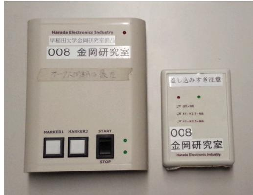
図 2-4. 増幅器（左）と筋電テレメーター（右）
