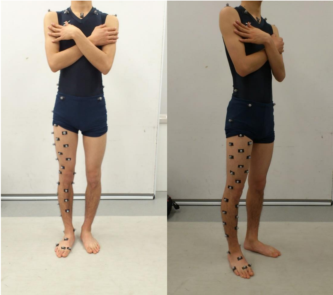
図 2 - 1 反射マーカ配置 (文献[57-59]に基づき貼付)
