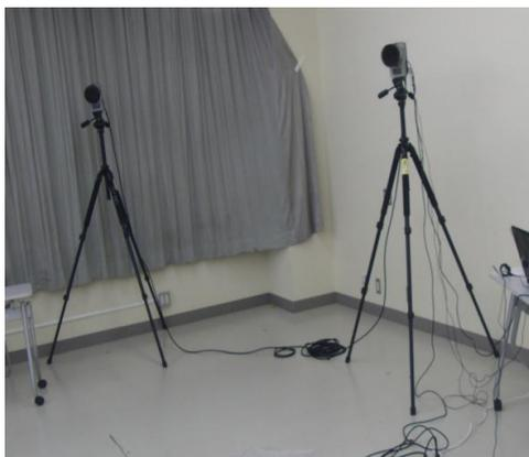
図 2-4. OQUS カメラ設置図
