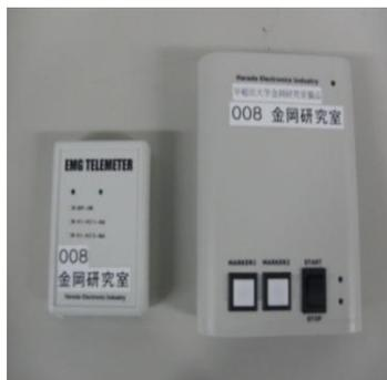
図 2-1. 表面筋電位測定装置
