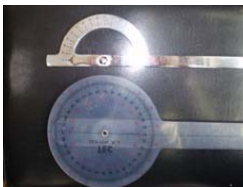
図 8. ゴニオメーター (角度計) 各種。右図下がアーム部分の柔軟性が高いもの。
